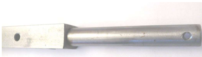
Achse einfach, Achszapfen in Bohrung gesteckt
