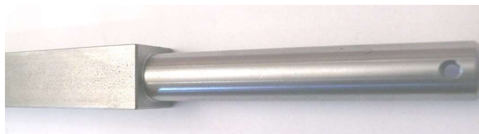
Achse verbessert, Achszapfen angedreht
